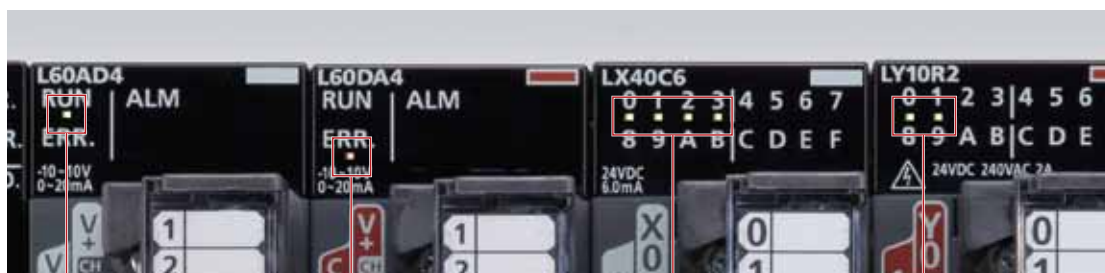
Los LED están situados en la superficie delantera superior de los módulos.
