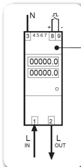
Reset contador parcial para puesta a cero (Bajo tapa de bornas)
