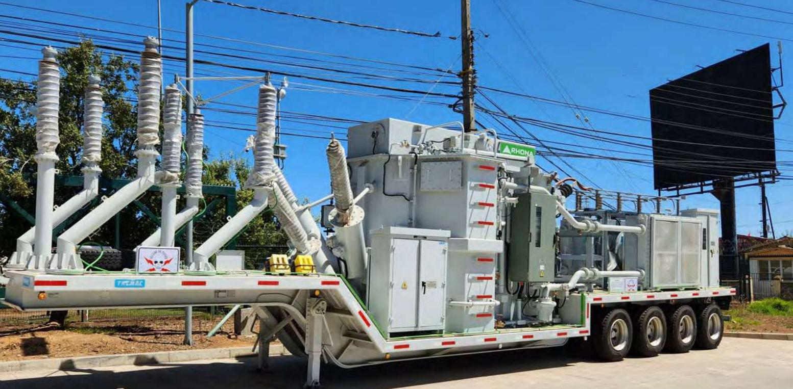
Transformador móvil 30 MVA 110kV
