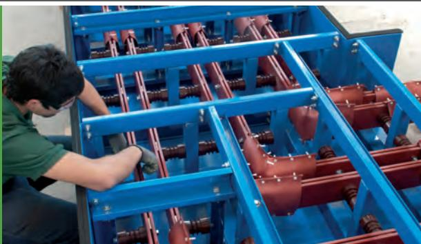
Los ductos de barra son una canalización eléctrica pre-ensamblada que permite una interconexión segura y confiable entre centros de distribución de carga y transformadores o para la alimentación de cargas dispersas.
